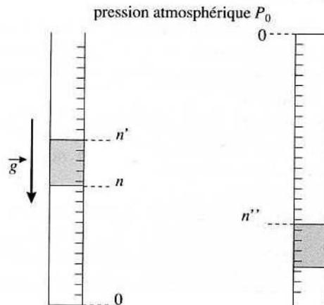
On retourne le tube ; on attend l'équilibre thermique. On lit la position  $n''$  de l'extrémité supérieure de l'index de mercure.
