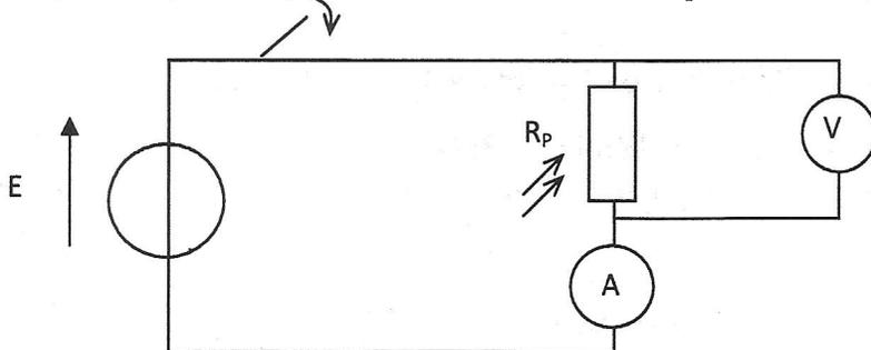
a- Avant d'allumer l'alimentation, évaluer l'ordre de grandeur du courant circulant dans la photorésistance et choisir le calibre de l'ampèremètre le mieux adapté.
