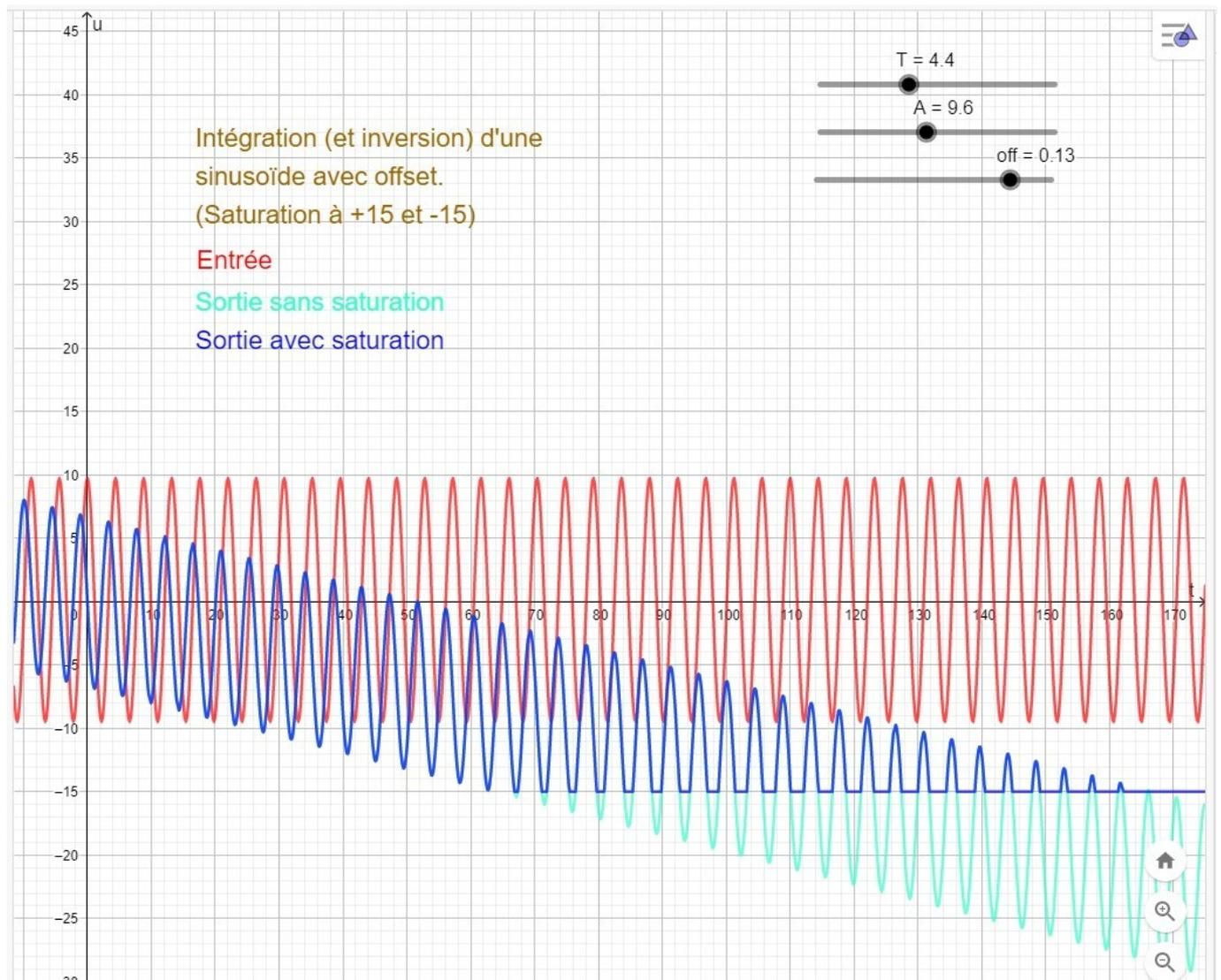
Le montage n'est donc pas stable et saturera en sortie : la tension de sortie ne peut pas sortir de l'intervalle  $[V_{\text{sat,-}} ; V_{\text{sat,+}}]$
