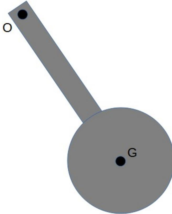
La tige plate (qui relie l'axe au cylindre) est de masse négligeable par rapport à la masse  $M$  du cylindre (appelé disque : son épaisseur ne joue pas de rôle dans les calculs), de centre  $G$  et de rayon  $R$ .
