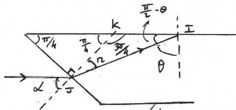
il y a réflexion totale si  $\theta \geq \theta_L$  où  $\theta_L = \arcsin \frac{1}{n}$
