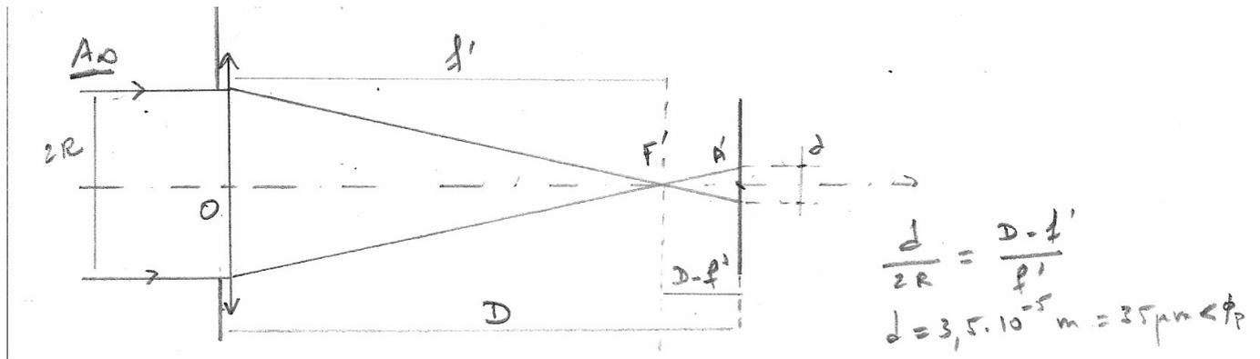
1.d Plus A est proche de la lentille, plus l'image A' sera située loin après. Donc si A se rapproche, l'image se forme après le détecteur et on obtient une tache image à nouveau. À la limite, son diamètre est juste celui d'un pixel  $\phi_p$  :
