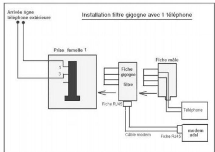
ADSL signifie « Asymmetric Digital Subscriber Line » (ligne numérique asymétrique d'abonné). Asymétrique, car le flux de données est plus important dans le sens descendant (réception, download) de transmission que dans le sens montant (émission, upload), dans un rapport qui varie entre 5 et 20.
