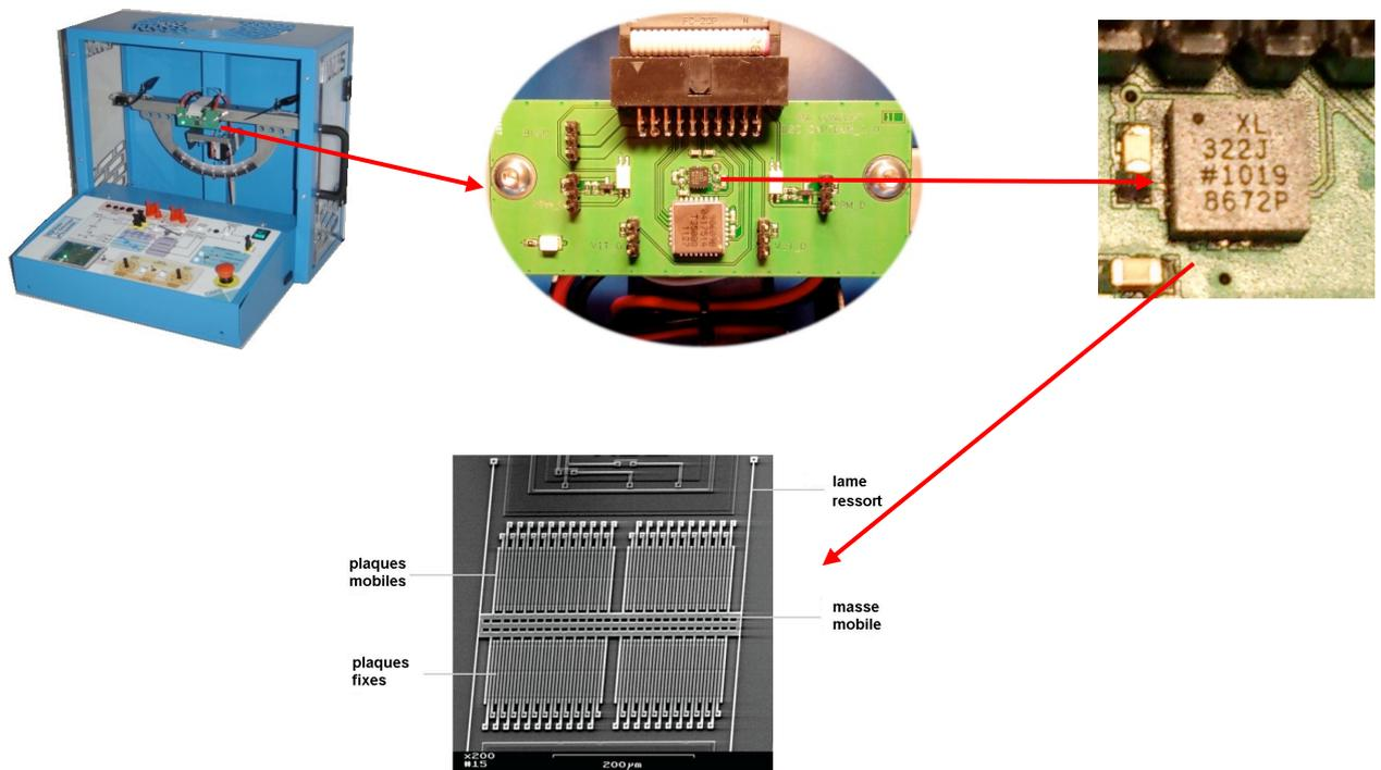
L'accéléromètre se compose de deux puces de silicium : l'élément de mesure et le circuit d'interprétation. Le cœur de l'élément de mesure dans sa structure n'est reconnaissable qu'au microscope.
