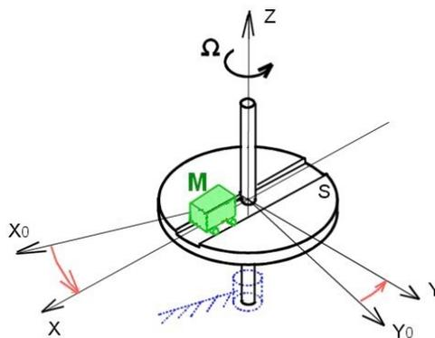
Les lois de la mécanique qui s'appliquent à ce mobile M, permettent de mettre en évidence le fait que lorsqu'il se déplace radialement à la vitesse V par rapport à S (dans la direction X), il subit une accélération « a » dite « accélération de Coriolis » qui s'exerce dans la direction Y.
