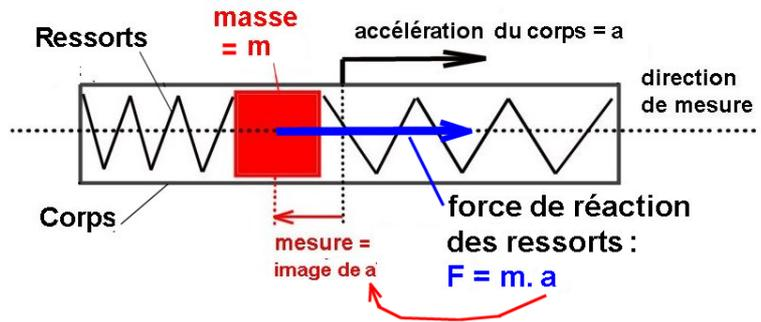
La mesure fournie par le capteur est une image de cette force, et est donc une image de « a ».
