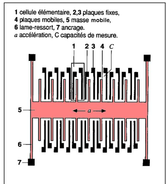
Un schéma équivalent qui représente bien le fonctionnement mécanique de l'accéléromètre à un axe est le « système masse-ressort » : fonction pour laquelle l'accéléromètre a été conçu : « mesurer l'accélération selon la direction de mesure « dm » »
