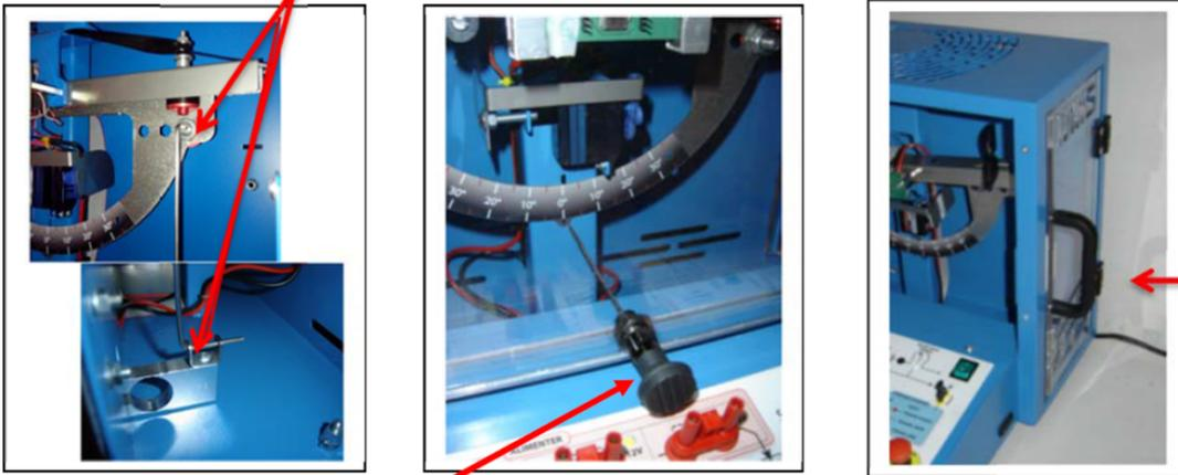
La **tige élastique** de blocage (au centre) placée doit être **en position tirée** (et bloquée dans cette position).
