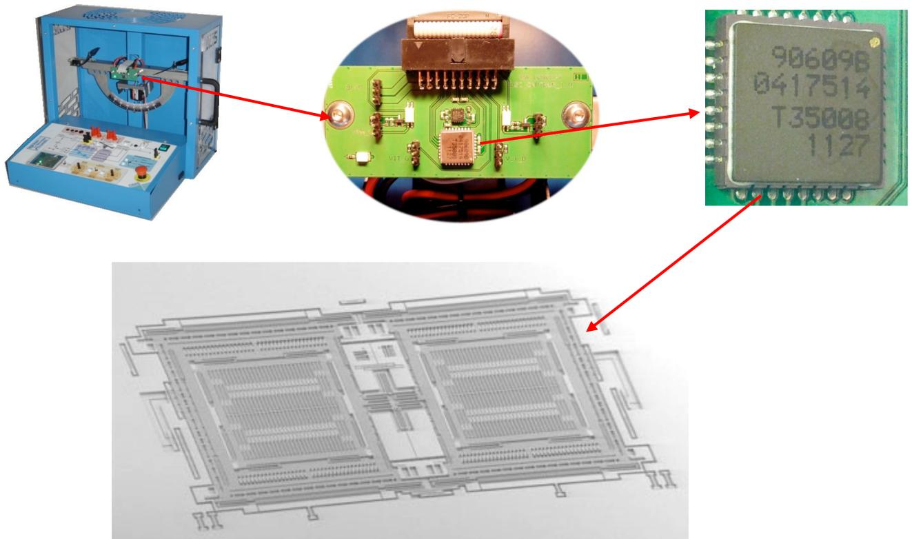
Le gyromètre se compose de puces de silicium : principalement pour l'élément de mesure et le circuit d'interprétation.
