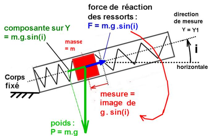
Axes de l'accéléromètre fixés par le constructeur :
