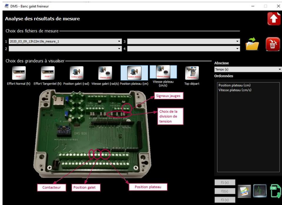
Sélectionner la ou les mesures à visualiser ainsi que les grandeurs en abscisse et en ordonnée. Cliquer sur le bouton figure en bas à droite pour visualiser les courbes.
