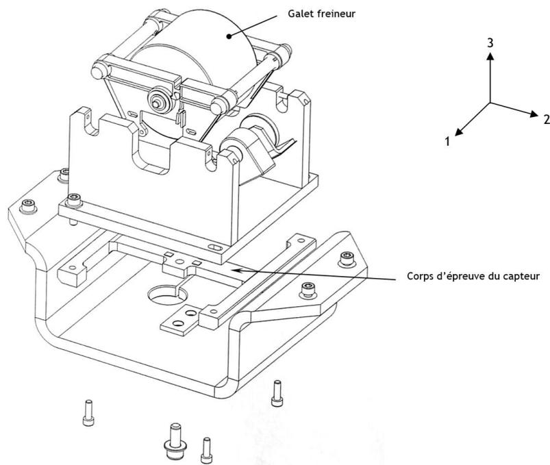
Une cale est positionnée entre le support galet et le capteur par l'intermédiaire de deux vis en acier pour permettre le maintien du capteur par rapport à la cassette et quatre autres vis en Inox pour le maintien du support galet. Cette cale permet au capteur de se déformer librement sur une course de 1 mm, la butée de fin de course étant réalisée par le fond de la cassette (nécessaire pour le cas où le capteur se déformerait trop).
