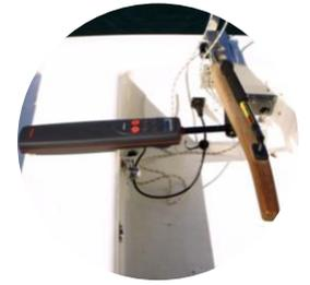
L'objectif de cette partie est de déterminer, via des mesures expérimentales sur le système didactisé, la relation entre la vitesse de rotation du moteur et la vitesse de sortie de tige (loi « entrée/sortie » de la chaîne d'énergie) et d'en évaluer les performances.
