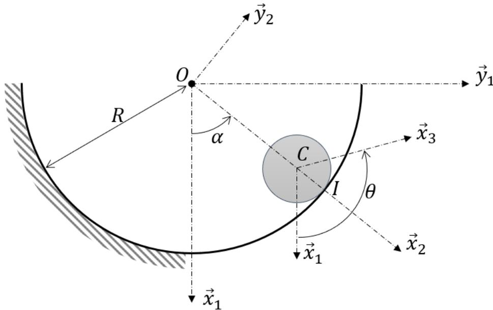
**Question 1:** En traduisant sous forme de liaison les mouvements **des repères** entre eux, réaliser un graphe des liaisons.
