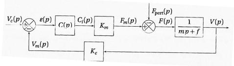
Q.7. Déterminer la fonction de transfert en boucle ouverte  $\frac{V_m(p)}{\varepsilon(p)}$  ainsi que la fonction de transfert en boucle fermée  $\frac{V(p)}{V_c(p)}$  en considérant la perturbation nulle  $F_{pert}(p)=0$ .
