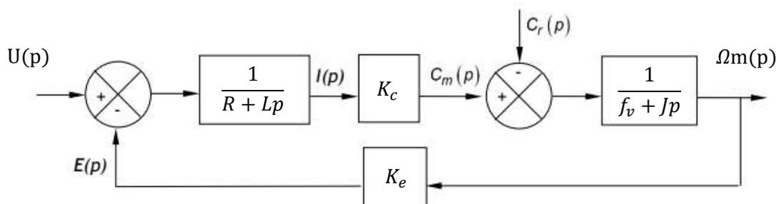
**Q.6.** Déterminer la fonction de transfert  $H_1(p) = \frac{\Omega_m(p)}{U(p)}$  sans perturbation ( $C_r(p) = 0$ ).
