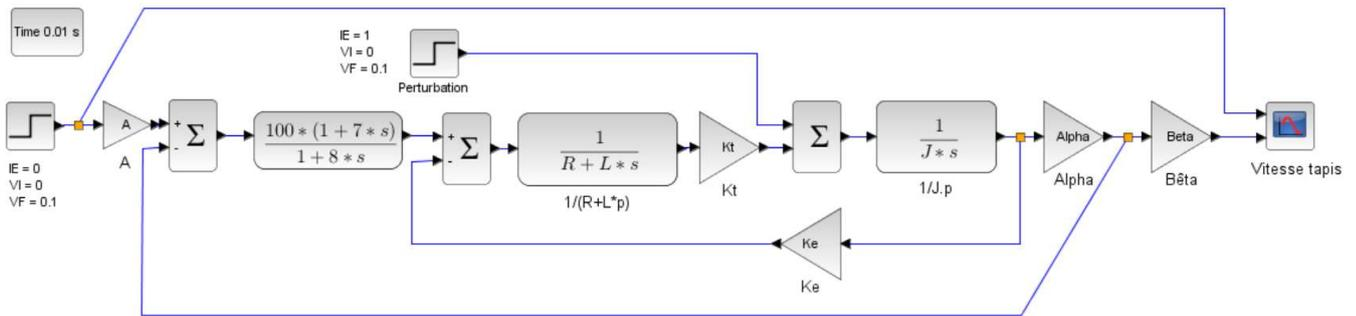
**Q.13.** Vers quelle valeur tend la sortie et quelle est la valeur de  $t_{r5\%}$  ? Conclure sur le schéma réel de l'asservissement et sur l'importance du correcteur vue à travers cet exemple.
