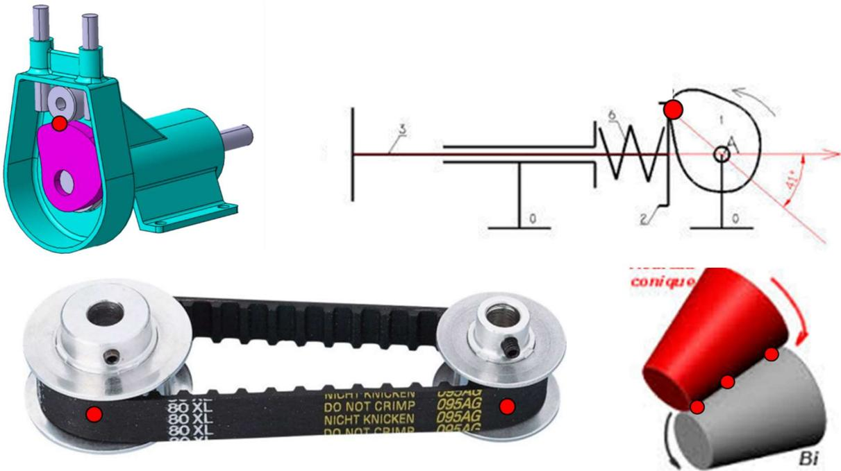
Une bonne partie des systèmes de transformation de mouvement utilisent un contact ponctuel ou équivalent. Nous allons mettre en place les méthodes de résolution liées à ce type de système.
