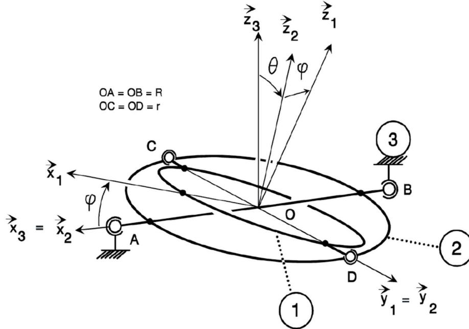
Schéma cinématique du dispositif d'orientation du miroir de tilt
