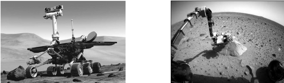
FIGURE 3 – Représentation d'artiste du robot Spirit et prise de vue de la cible depuis la caméra panoramique implantée sur la tête périscopique.
