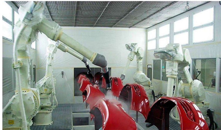
Robot de peinture sur une chaîne d'assemblage automobile
