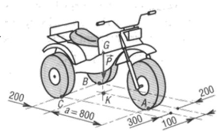
**Question 1:** Déterminer les actions mécaniques en  $A$ ,  $B$  et  $C$ .
