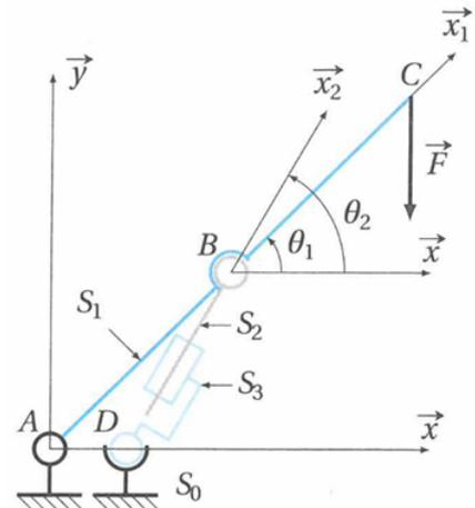
**Question 2:** Réaliser le graphe d'analyse du système. Préciser les actions mécaniques connues et celles recherchées.
