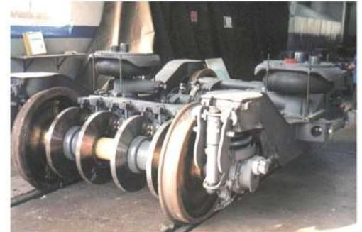
La masse de la rame, estimée à 424 tonnes, est supposée également répartie sur chacune des roues. Cette hypothèse permet de limiter l'étude à une roue avec ses deux disques et les composants associés.
