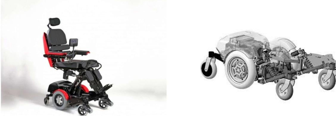
**Objectif :** vérifier que les groupes motoréducteurs des roues motrices permettent au WHING de gravir une pente de  $15^\circ$  nécessaires pour monter dans un véhicule de transport.
