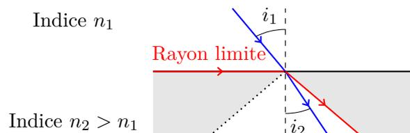
**Fig. 4** – Tous les rayons réfractés seront situés à l'intérieur du cône de réfraction. Aucun rayon réfracté ne sera dans la zone grise.
