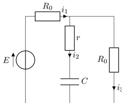
On appelle  $U_j$  la tension en convention récepteur aux bornes de la résistance  $R_j$ .
