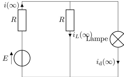
En associant les différentes résistances du circuit, on trouve une résistance totale équivalente de  $R_{tot} = \frac{4}{5}R + R = \frac{9}{5}R$  donc un courant  $i(\infty) = \frac{5E}{9R}$ .
