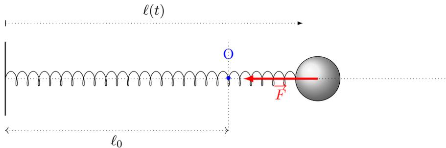
**Fig. 2** – Schéma du problème du système masse-ressort horizontal.
