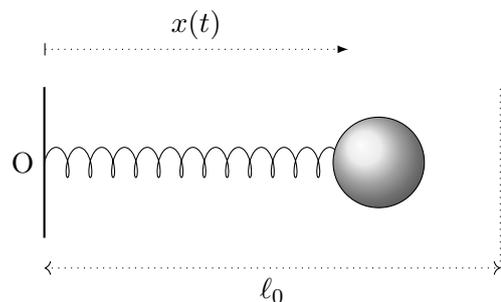
On appelle  $x(t)$  la longueur du ressort à l'instant  $t$ . L'étude mécanique du système permet d'obtenir l'équation du mouvement de la masse :
