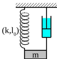
Nous nous proposons de déterminer expérimentalement les caractéristiques mécaniques ( $m, b, k$ ) de l'accéléromètre schématisé par la figure ?? ci-contre.
