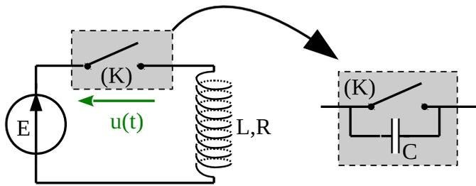
On considère le montage de la figure ci-contre comprenant notamment une bobine réelle d'inductance  $L = 10 \text{ mH}$  et de résistance  $R = 10 \Omega$ . On donne  $E = 1.0 \text{ V}$ .
