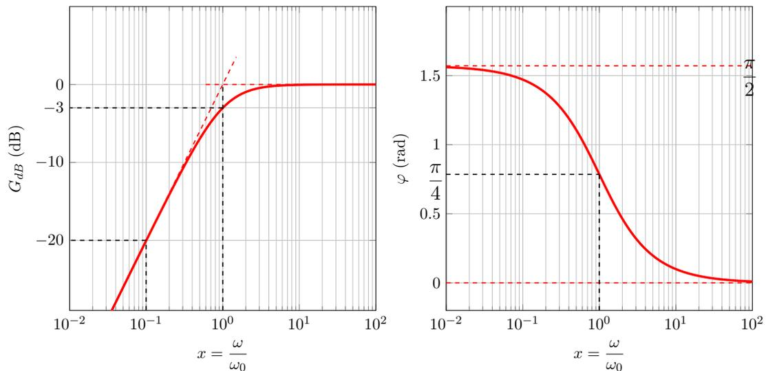
**Fig. 7** – Diagramme de Bode du filtre passe-haut d'ordre 1
