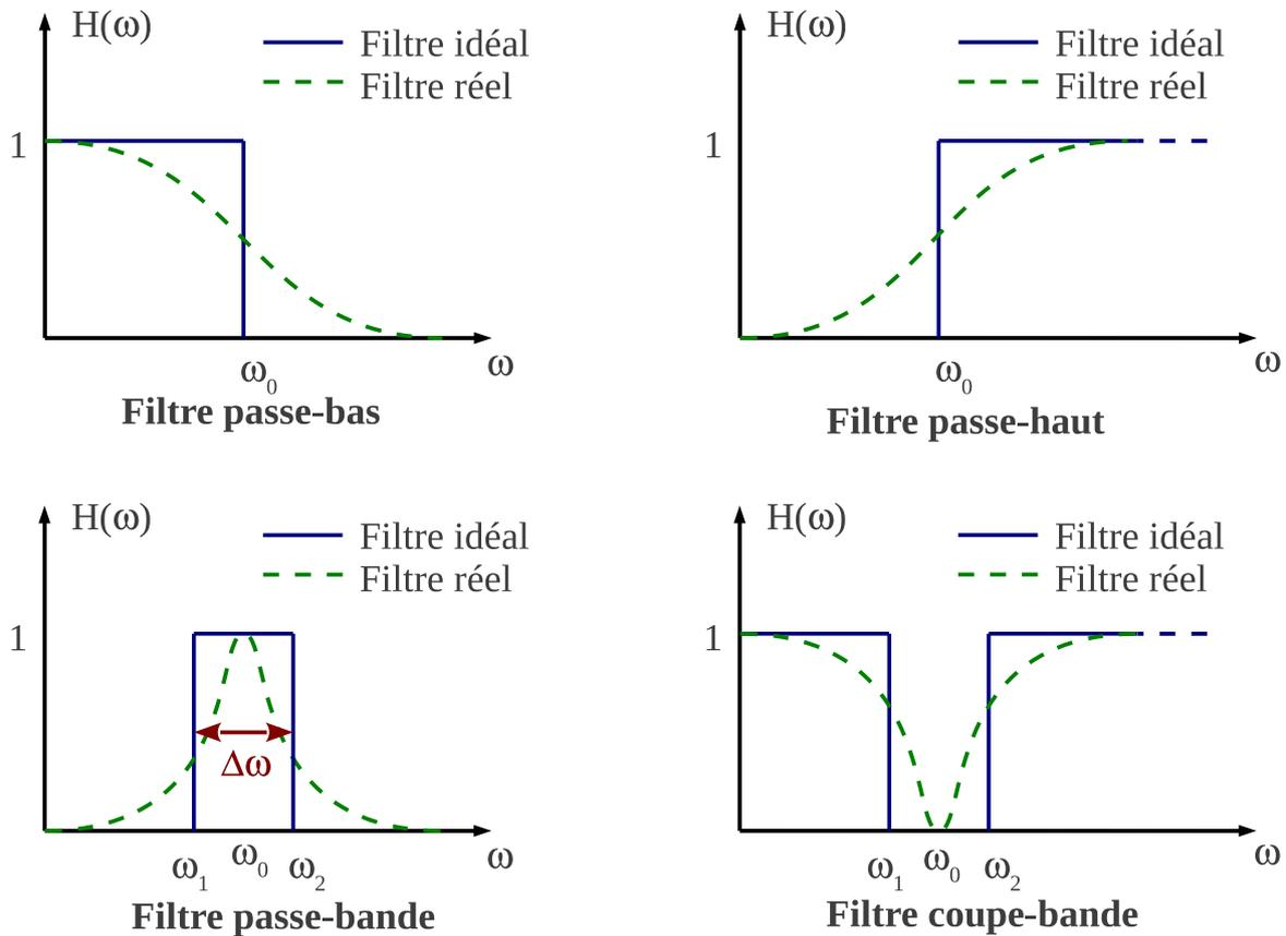
**Fig. 4** – Différents types de filtres : Passe-bas et passe-haut ; passe-bande et coupe bande. Dans le cas idéal, la bande passante correspond à l'intervalle de pulsation sur lequel le module  $H(\omega)$  est non nul.
