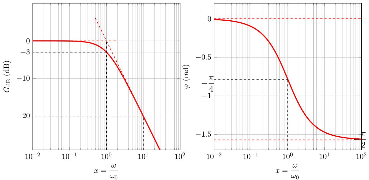
**Fig. 2** – Diagramme de Bode du filtre passe-bas d'ordre 1.
