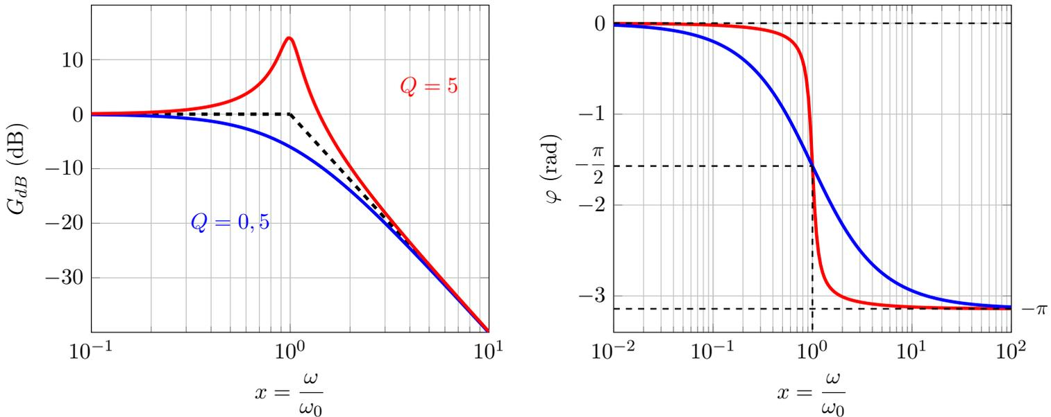
**Fig. 8** – Diagramme de Bode du filtre passe-bas d'ordre 2.
