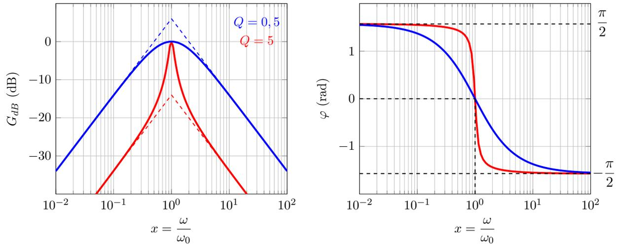
Fig. 9 – Diagramme de Bode du filtre passe-bande d'ordre 2
