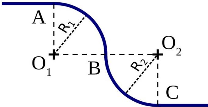
On considère un mobile se déplaçant à la vitesse  $v = 70\text{km/h}$  constante sur une trajectoire formée de deux segments rectilignes parallèles (avant A et après C), raccordés par deux quarts de cercles rayon  $R_1$  et  $R_2$ , avec  $R_2 > R_1$  (même si ce n'est pas visible sur la figure) et de centre  $O_1$  et  $O_2$ .
