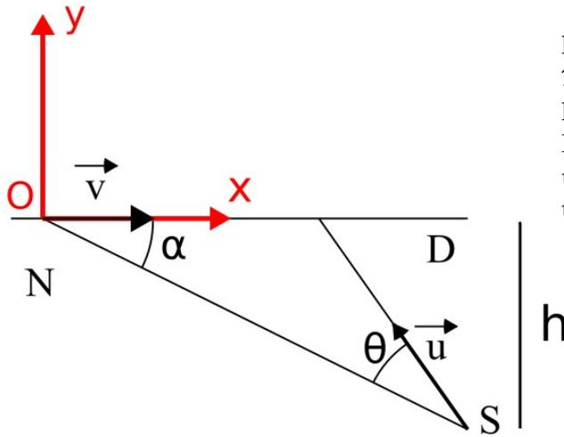
Un navire N est animé d'un mouvement rectiligne uniforme de vitesse  $\vec{v}$ , le long d'une droite  $\mathcal{D}$ . Un sous-marin immobile S tire une torpille T à l'instant  $t = 0$  où l'angle  $(\overrightarrow{NS}, \vec{v})$  a la valeur  $\alpha$ . La torpille est animé d'un mouvement rectiligne uniforme de vitesse  $\vec{u}$ . On introduit un repère cartésien  $O, \vec{e}_x, \vec{e}_y$ .
