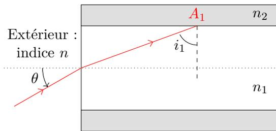
Pour que la lumière reste confinée dans le coeur de la fibre, il ne doit pas avoir de rayon réfracté au niveau du point  $A_1$ . Pour cela, il doit avoir **réflexion totale**. Pour que cela soit possible, le milieu de la gaine doit avoir un indice plus petit que celui du coeur :  $n_2 < n_1$ .
