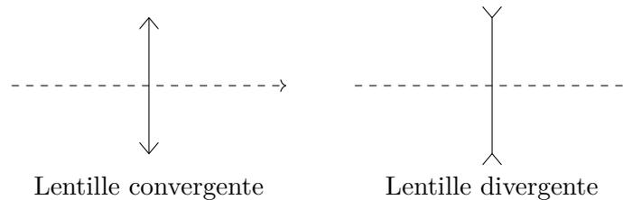
**Fig. 1** – Représentation schématique des lentilles.
