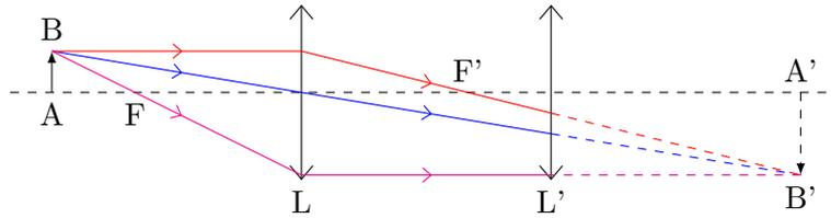
L'objet initial  $AB$  a pour image  $A'B'$  à travers la lentille  $L$ . Pour la lentille  $L$ , l'image  $A'B'$  est réelle. Or cette image est derrière la lentille  $L'$ . Ainsi,  $A'B'$  est un objet virtuel pour cette seconde lentille  $L'$ .
