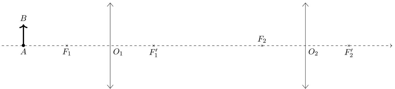
On assimile l'objectif à une lentille mince convergente  $\mathcal{L}_1$  de distance focale  $f'_1 = 5,0\text{mm}$ . L'objet  $\overline{AB}$  assimilé à un segment de droite perpendiculaire à l'axe optique, avec  $A$  sur l'axe, est placé à  $d = 8,25\text{mm}$  devant le centre optique  $O_1$  de  $\mathcal{L}_1$ . On note  $h$  la taille de  $AB$ .
