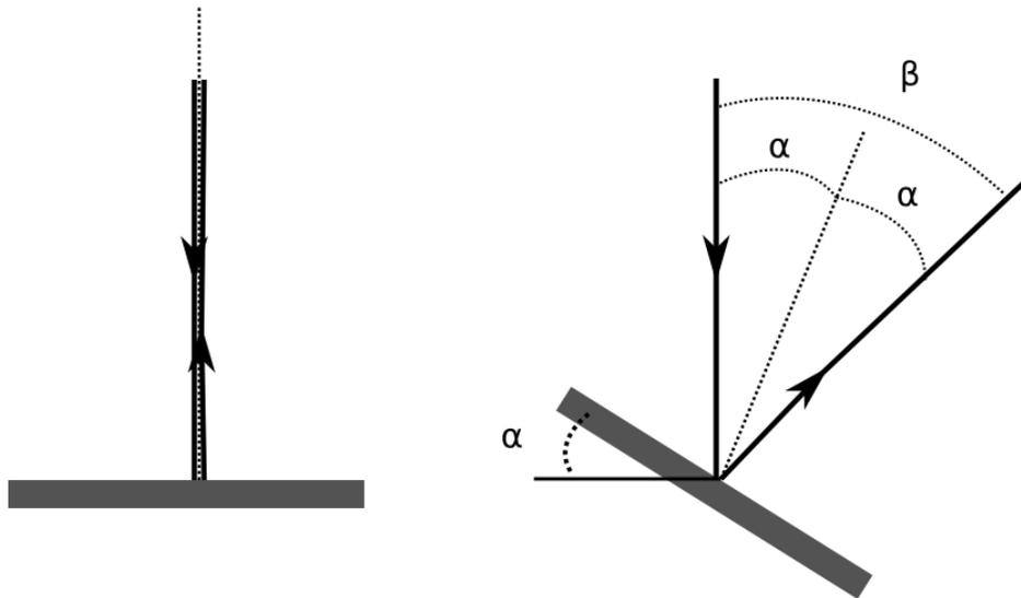
Si on penche le miroir d'un angle  $\alpha$  alors l'angle d'incidence d'un rayon vertical est également  $\alpha$ .
