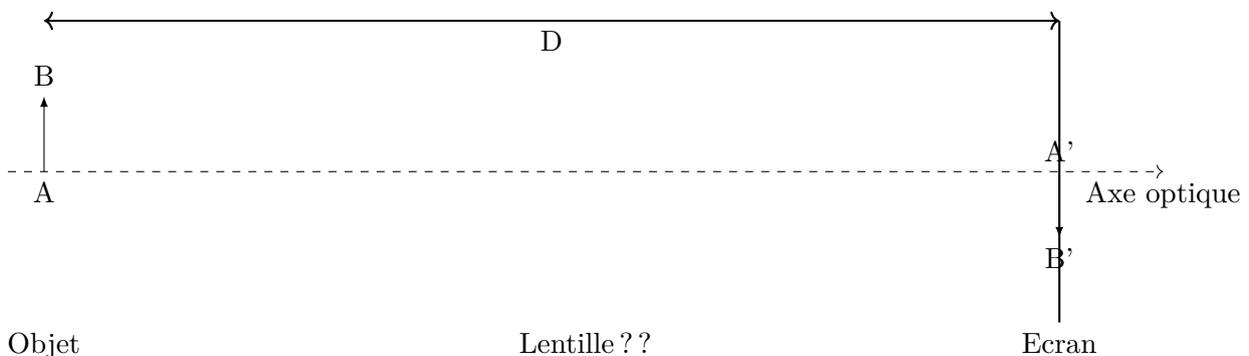
**Objectif :** montrer qu'il existe deux positions possibles pour la lentille pour qu'on puisse visualiser une image sur l'écran et donner une condition sur  $D$  pour que cela soit possible.
