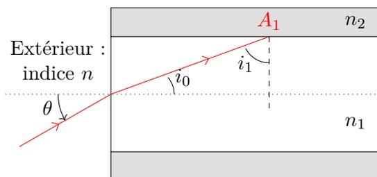
On appelle  $i_0$  l'angle du rayon réfracté au niveau de l'entrée du rayon dans la fibre.
