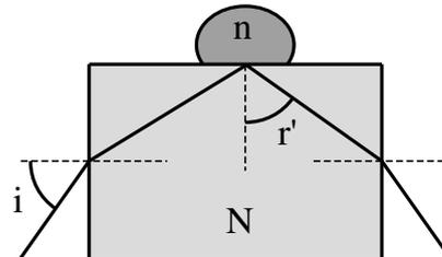
1. On considère le cas d'une réflexion totale sur le dioptre  $N \rightarrow n$ . Exprimer, en fonction de  $n$  et  $N$ , la valeur limite  $i_0$  de  $i$  au delà de laquelle il n'y a plus de réflexion totale.
