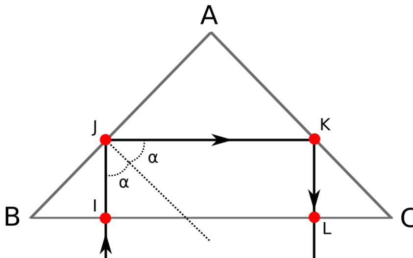
2. On retrouve une configuration proche. Avec un raisonnement similaire on retrouve la trajectoire suivante (incidence normale en  $I$  et  $K$ , réflexion totale en  $J$ ) :
