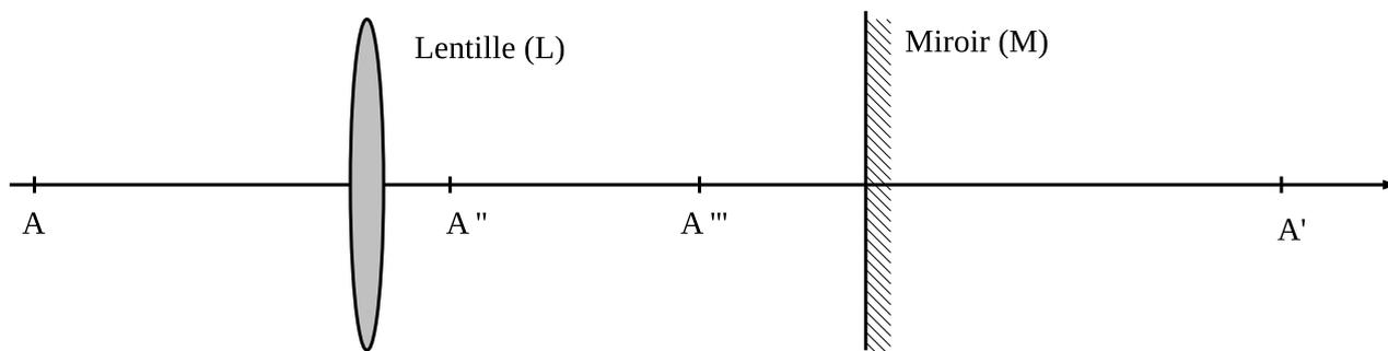
Les rayons lumineux provenant du point objet A traversent la lentille L, sont réfléchis sur le miroir plan M et traversent à nouveau la lentille L.
