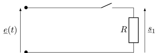
Tension aux bornes d'une résistance sans courant
