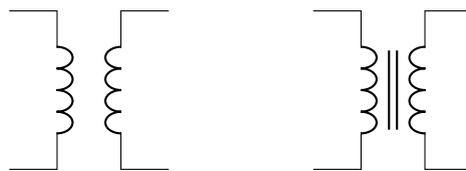
Pour utiliser un transformateur, on met une source de tension variable au niveau du primaire. L'intensité  $i_1$  parcourant les boucles de courant crée un champ magnétique variable. Ce champ magnétique induit un courant au niveau du secondaire.
