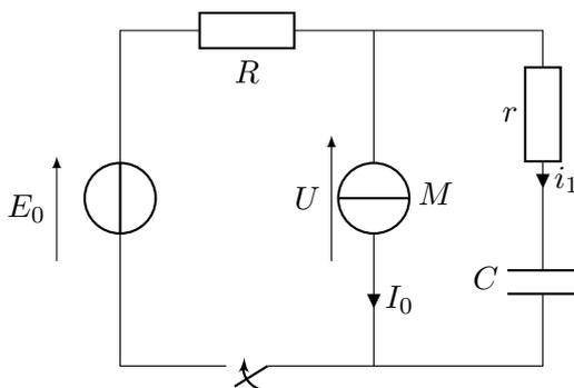
Pour que le moteur puisse continuer à fonctionner, on branche en parallèle de ce dernier une batterie qui, une fois chargée, permettra d'alimenter le moteur pendant la perte de contact.
