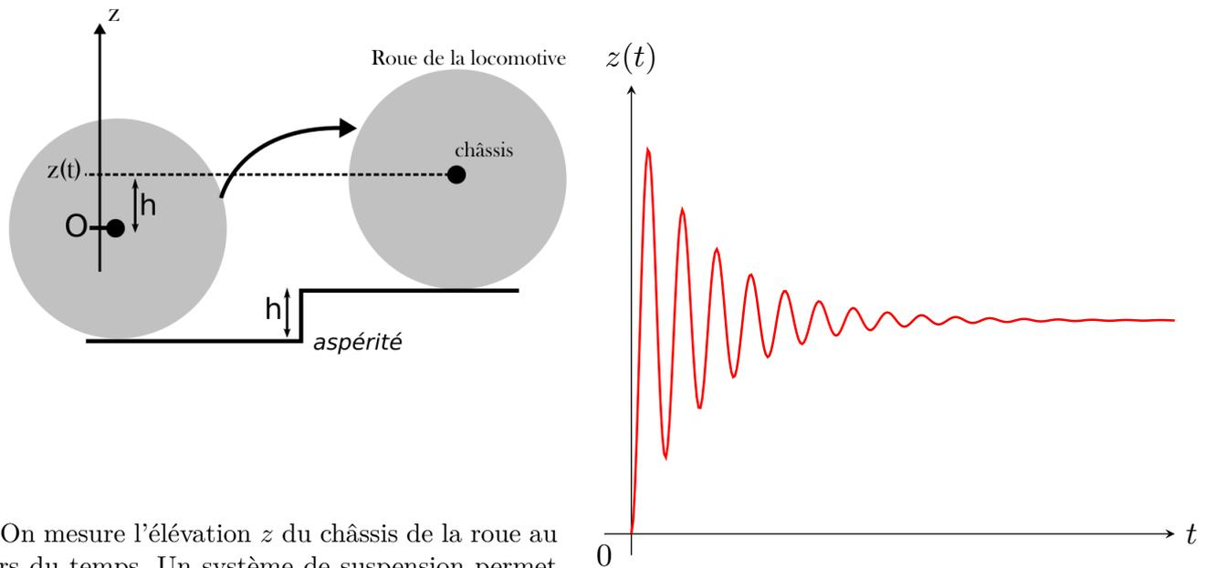
On mesure l'élévation  $z$  du châssis de la roue au cours du temps. Un système de suspension permet de faire la transition entre les deux positions "en douceur".
