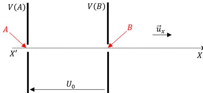
Des électrons (de charge  $q = -e$ ) pénètrent avec une vitesse initiale négligeable à l'entrée de l'accélérateur linéaire en  $A$ . On suppose que le champ électrique, noté  $\vec{E}_0$  est uniforme et stationnaire entre les deux plaques de l'accélérateur.
