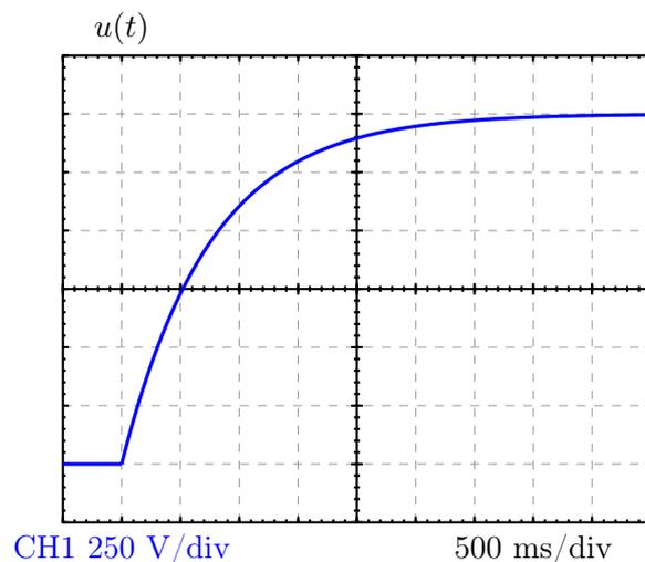
**A.6** En réalité la résistance mesurée à la question précédente ne correspond pas à la résistance introduite entre l'alimentation et le condensateur puisque, l'alimentation ne peut pas être considérée comme une source idéale de tension. On doit alors prendre en compte la résistance de sortie de l'alimentation :  $R_g$ . Déterminer alors  $R_g$  en considérant que  $R = 1,2 \text{ k}\Omega$ .
