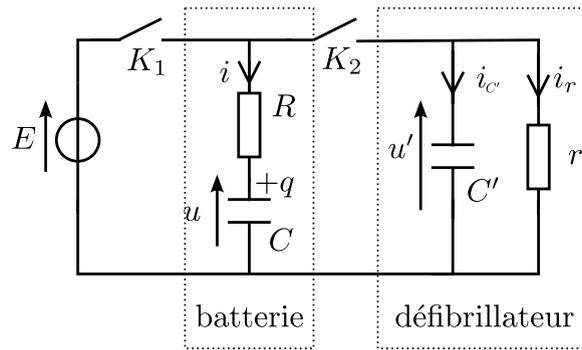
A l'instant  $t' = 0$ , on ouvre l'interrupteur  $K_1$  et on ferme l'interrupteur  $K_2$ . Le condensateur  $C$  porte alors la charge  $q = CE$  et le condensateur  $C'$  est déchargé.
