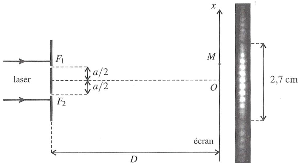
Sur l'écran on observe une figure symétrique autour d'un point  $O$ , la lumière se répartissant le long d'un axe  $(Ox)$  perpendiculaire aux fentes. On observe une tache centrale très lumineuse de largeur 2,7 cm dont l'éclairement est modulé et des tâches latérales, deux fois plus étroites et beaucoup moins lumineuse présentant la même modulation de l'éclairement. Le but de l'exercice est d'interpréter ces observations.
