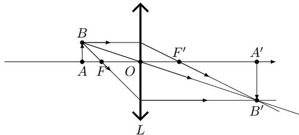
**A.2** D'après le théorème de Thalès, et la construction ci-dessus, on obtient le grandissement  $\gamma = \frac{\overline{A'B'}}{\overline{AB}} = \frac{\overline{FO}}{\overline{FA}} = \frac{f'}{FA}$  et  $\gamma = \frac{\overline{A'B'}}{\overline{AB}} = \frac{\overline{F'A'}}{\overline{F'O}} = -\frac{\overline{F'A'}}{f'}$ .
