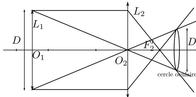
**D.2**  $C$  est l'image de  $O$  par  $L_2$ . En utilisant la formule de Newton, on obtient  $\overline{F_2' C} \cdot \overline{F_2 O_1} = -f_2'^2$  et  $\overline{F_2 O_1} = \overline{F_2 F_1'} + \overline{F_1' O_1} = -\Delta - f_1'$ . On obtient alors  $\overline{F_2' C} = \frac{f_2'^2}{f_1' + \Delta} = 5,6 \text{ mm}$ .
