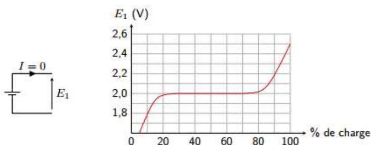
La figure ci-dessous représente la caractéristique statique d'un accumulateur chargé à 50%. On rappelle que la caractéristique d'un générateur décrit la façon dont varie la tension  $U$  à ses bornes lorsqu'il débite un courant  $I$  non nul.
