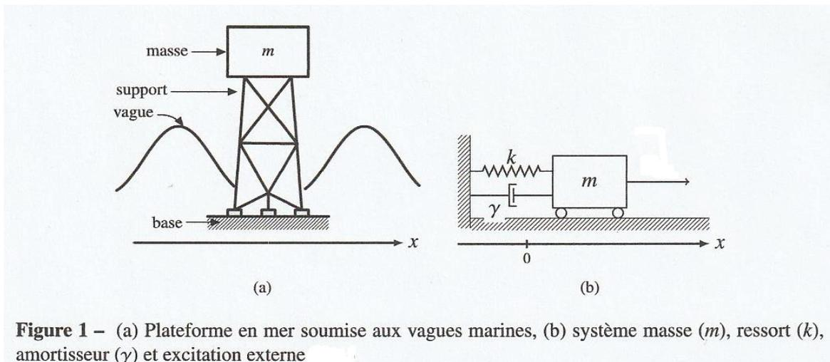
**Figure 1** – (a) Plateforme en mer soumise aux vagues marines, (b) système masse ( $m$ ), ressort ( $k$ ), amortisseur ( $\gamma$ ) et excitation externe
