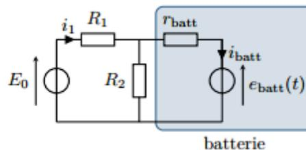
8) À quel dipôle la batterie est-elle équivalente au début de la charge, lorsqu'elle est complètement déchargée ? En déduire la valeur  $i_0$  de l'intensité  $i_{\text{batt}}$  du courant qui la traverse.
