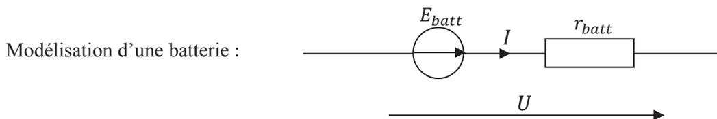
En convention générateur :  $U = E_{\text{batt}} - r_{\text{batt}} \cdot I$  A.N. :  $E_{\text{batt}} = 12 \text{ V}$  et  $r_{\text{batt}} = 0,30 \Omega$ .
