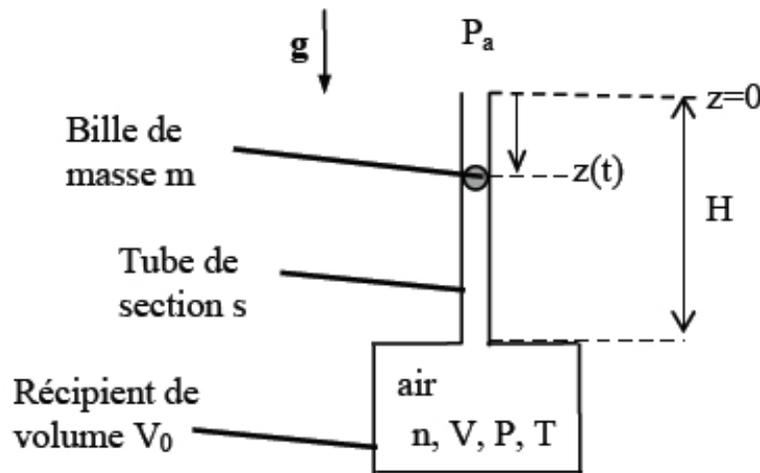
On note  $P_a = 1,0 \text{ bar}$  la pression atmosphérique. On néglige les frottements dans un premier temps, l'intensité du champ de pesanteur vaut  $g = 10 \text{ m.s}^{-2}$ . Dans tout le problème, les gaz sont supposés parfaits. On note  $n$  le nombre de moles d'air enfermé dans le système,  $P$  sa pression,  $V$  son volume et  $T$  sa température.
