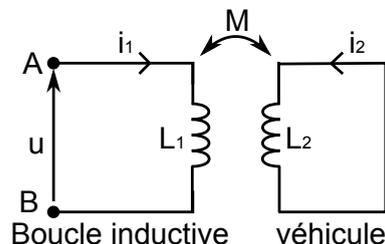
1. Montrer qu'en présence du véhicule, le dipôle  $AB$  est équivalent à une inductance propre  $L'$  qu'on exprimera en fonction de  $L_1$ ,  $L_2$  et  $M$ .
