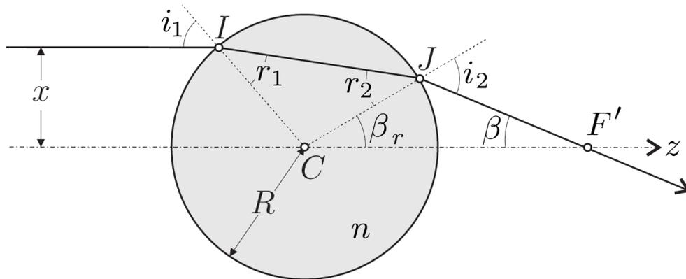
Les angles formés entre les rayons lumineux et les normales aux dioptres sont notés  $i_1$ , au point  $I$  en entrée de la lentille et  $i_2$  à l'extérieur de la lentille au point  $J$ , en sortie. De même, les angles intérieurs seront notés  $r_1$  et  $r_2$ . L'angle  $F' CJ$  est noté  $\beta_r$  et l'angle de déviation  $CF'J$  sera noté  $\beta$ .
