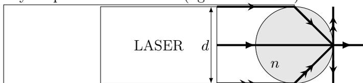
Nous constatons que le faisceau est fortement élargi à la sortie de la baguette. La figure ci-dessus propose le tracé de trois rayons lumineux.
