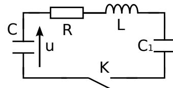
1. Quelle est l'équation différentielle satisfaite par l'intensité  $i(t)$  circulant dans le circuit ?
