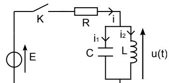
1. Déterminer les conditions initiales et finales pour  $i_1$ ,  $i_2$  et  $u$ .
