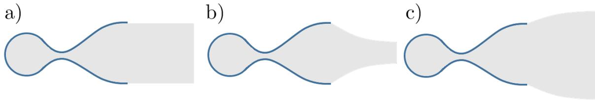
FIGURE 3 – Les trois régimes de fonctionnement de la tuyère selon la situation de la pression du gaz à sa sortie, par rapport à la pression extérieure  $P_e$ . Le gaz de combustion occupe le domaine grisé.
