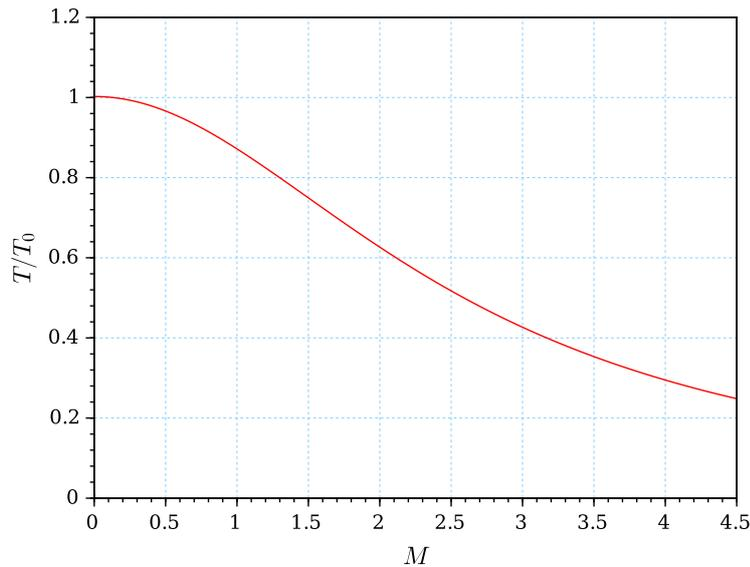
FIGURE 5 – Dépendance du rapport  $T/T_0$  avec  $M$ .
