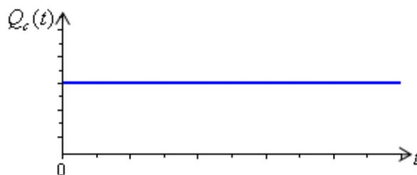
39. Le canal annulaire est le mieux approprié car il présente un débit contrôlable instantanément établi. Dans les cas (a) et (b) le débit est variable, initialement faible et peut être destructif lorsqu'il est assez important.
