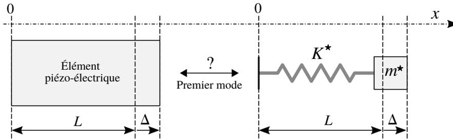
FIGURE 5 – Recherche de l'équivalence masse-ressort, d'un point de vue énergétique, de l'élément piézo-électrique, pour le premier mode.
