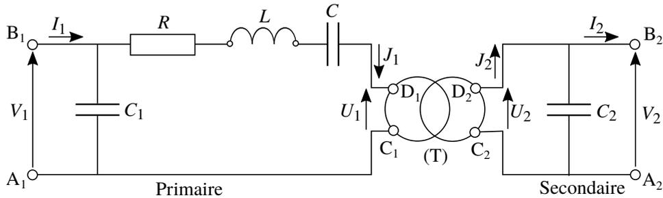
FIGURE 10 – Modèle électrique de deux éléments piézo-électriques en interaction formant un transformateur réalisant le conversion  $(V_1, I_1) \rightarrow (V_2, I_2)$ . Nous rappelons que les éléments  $R$ ,  $L$  et  $C$  traduisent, dans le domaine électrique, le comportement mécanique des deux éléments piézo-électriques couplés par l'intermédiaire de la masse  $M_o$ .
