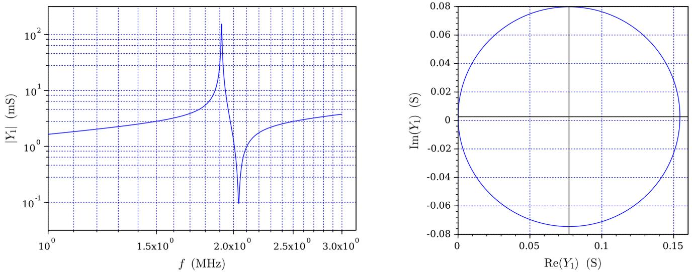
FIGURE 11 – Tracé de gauche : Dépendance du module de l'admittance complexe  $Y_1$  en fonction de la fréquence, en représentation  $\log_{10} - \log_{10}$ . Tracé de droite : Lieu de  $Y_1$  dans le plan complexe, paramétré par la pulsation, pour le même intervalle fréquentiel que sur le tracé de gauche. Ce lieu est parcouru dans le sens horaire, pour une évolution croissante de la pulsation.
