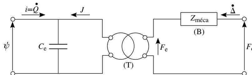
FIGURE 7 – Schématisation, en empruntant la symbolisation de l'électrocinétique, du système électromécanique représentant un élément piézo-électrique soumis à la différence de potentiel  $\psi$  et à la force extérieure  $F_o \vec{e}_x$ .
