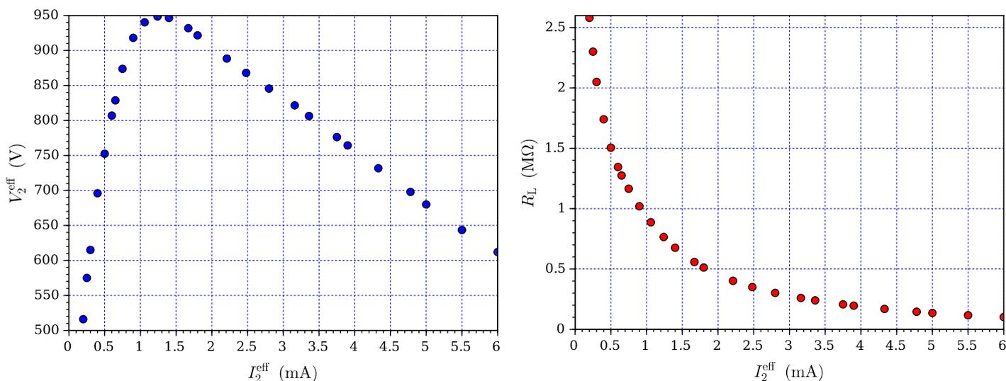
FIGURE 14 – À gauche : caractéristique courant-tension d'une LCF. À droite : dépendance de sa résistance, définie par le rapport  $V_2^{\text{eff}}/I_2^{\text{eff}}$ , avec le courant efficace la traversant.
