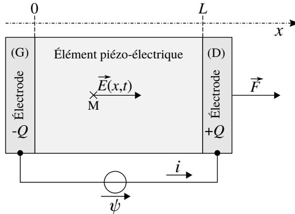
FIGURE 3 – Élément piézo-électrique comportant deux électrodes métalliques connectées à un générateur. Elles soumettent cet élément à la différence de potentiel  $\psi$ . Notons que c'est le signe de la composante algébrique  $E(x, t)$  qui donnera, localement en espace et en temps, le sens véritable du champ électrique  $\vec{E}$ .
