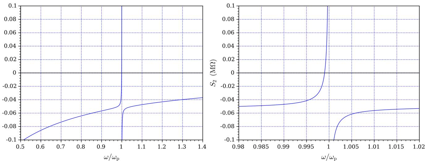
FIGURE 17 – Dépendance  $S_2 = S_2(\omega)$  pour le quartz d'impédance  $Z_2 = jS_2$ . Le tracé de droite est un agrandissement horizontal de la zone centrale du tracé de gauche. Afin que ces tracés restent exploitables, les cadres graphiques ont été restreints verticalement. L'échelle des ordonnées est commune aux deux tracés.
