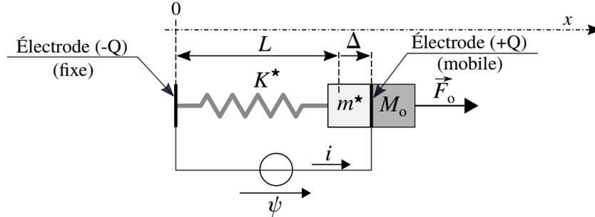
FIGURE 6 – Modèle mécanique  $(m^*, K^*)$  de l'élément piézo-électrique lié à un objet rigide de masse  $M_o$ . Ce dernier est soumis à une force  $\vec{F}_o = F_o \vec{e}_x$ , extérieure au système électromécanique  $(M = m^* + M_o, K^*, Q)$ . Les électrodes sont soumises à la différence de potentiel  $\psi$ .
