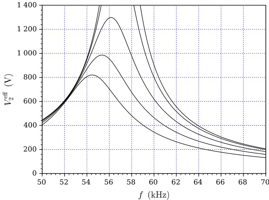
FIGURE 15 – Tension efficace  $V_2^{\text{eff}}$  de sortie du transformateur en fonction de la fréquence  $f$  pour  $V_1^{\text{eff}} = 15$  V et différentes valeurs de la charge :  $R_L = 140$  ; 200 ; 300 ; 500 et 750 k $\Omega$ . En suivant cet ordre, les *maxima* des courbes vont croissant.
