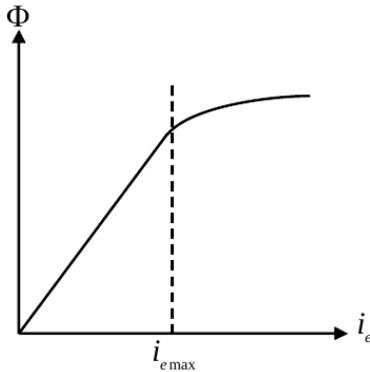
La courbe 2 fournit les variations de  $E_0$  suivant  $i_e$  avec  $E_0 = \Phi \Omega$ .
