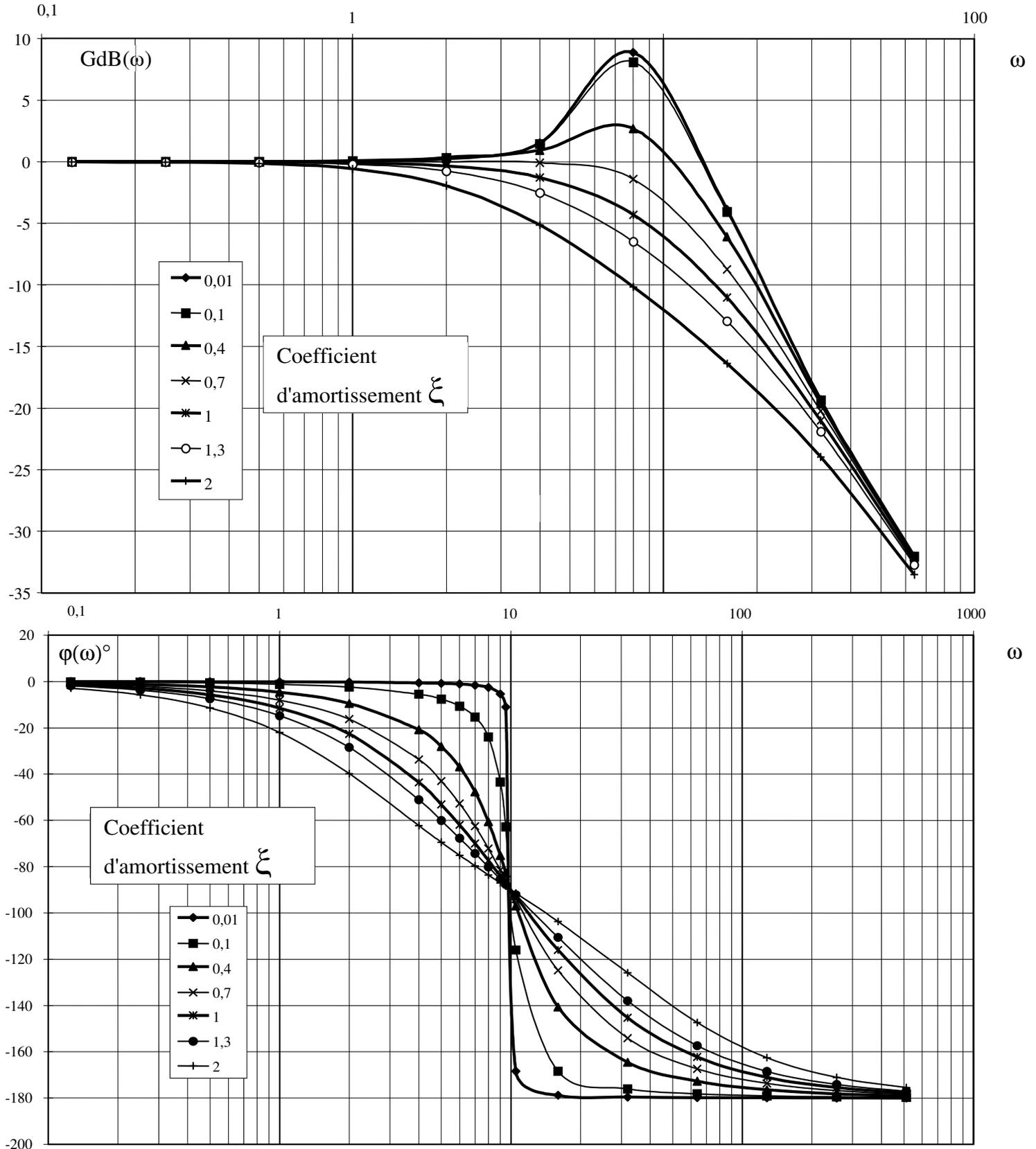
Evolution de la réponse fréquentielle d'un système du second ordre avec l'amortissement  $\zeta$
