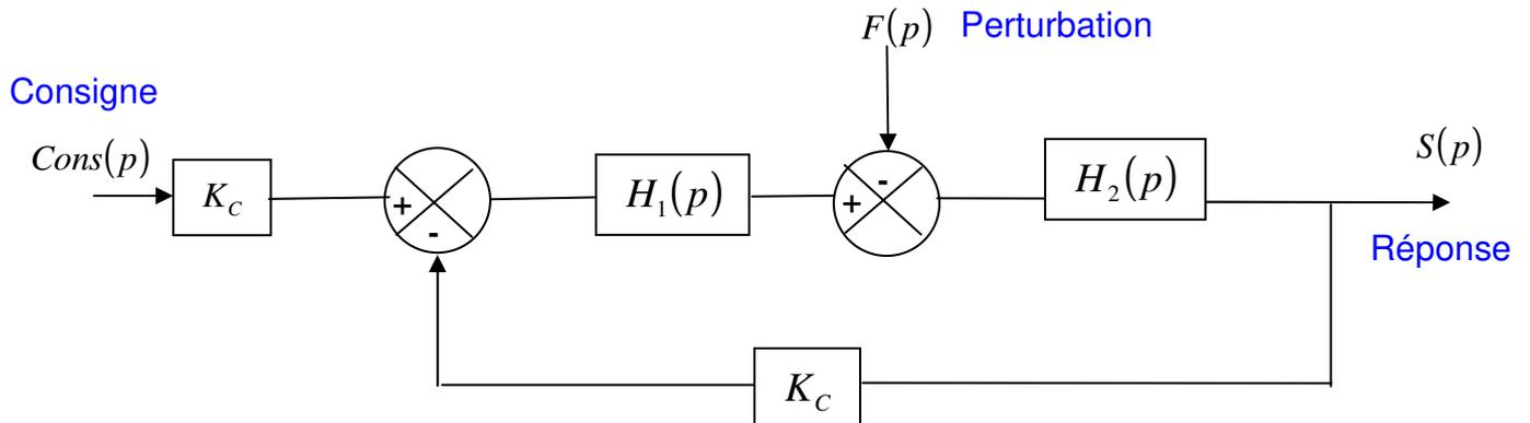
Le schéma bloc peut être considéré avec deux entrées : la consigne et la perturbation. En utilisant le théorème de superposition, nous pouvons calculer la double fonction transfert du système sous la forme:
