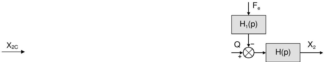
Schéma fonctionnel de la boucle d'asservissement en position du vérin
