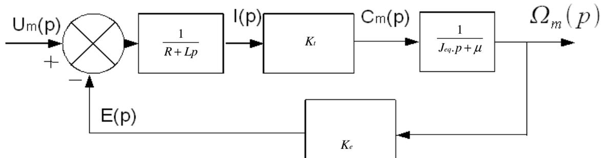
Il ne s'agit pas d'un système asservi puisque, bien que bouclé, le système ne comporte pas d'entrée et de sortie de même nature et qu'aucun capteur ne vient mesurer la valeur de la sortie.
