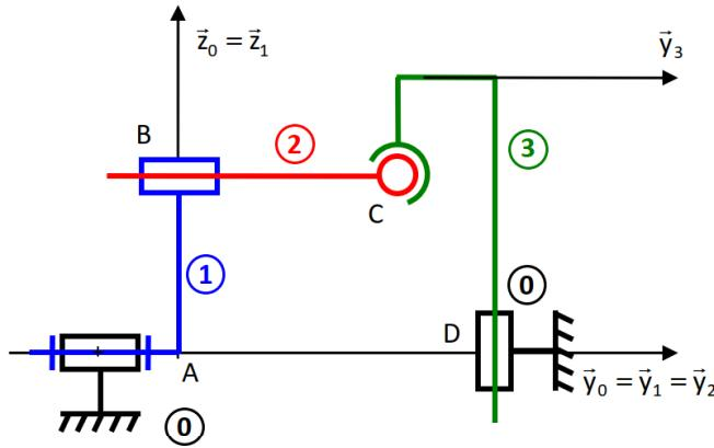
Q.4. Fermeture géométrique :  $\vec{AA} = \vec{0} \rightarrow \vec{AB} + \vec{BC} + \vec{CE} + \vec{ED} + \vec{DA} = R\vec{z}_1 + \lambda(t)\vec{y}_1 - h(t)\vec{z}_0 + L\vec{y}_3 - d\vec{y}_1$
