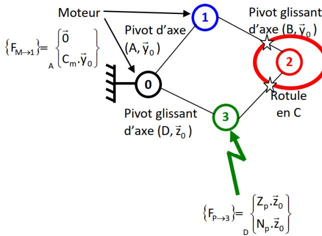
Attention le système est soumis à 2 actions mécaniques mais l'action mécanique du solide 2 sur le solide 2 n'est pas un glisseur !
