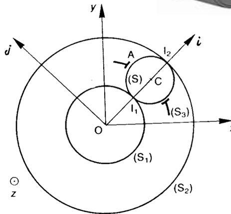
Soit  $R(O, \vec{x}, \vec{y}, \vec{z})$  un repère lié au bâti  $S_0$ . Les deux bagues  $S_1$  et  $S_2$  et la cage  $S_3$  sont en rotation autour de l'axe  $(O, \vec{z})$  par rapport à  $S_0$ . La bille  $S$ , de centre  $C$ , roule sans glisser en  $I_1$  sur  $S_1$  et en  $I_2$  sur  $S_2$ .
