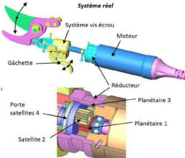
Lorsque l'utilisateur appuie sur la gâchette, le moteur transmet par l'intermédiaire d'un réducteur à train épicycloïdal un mouvement de rotation à la vis à billes. L'écrou se déplace en translation par rapport à la vis et par l'intermédiaire d'une bielle met en rotation la lame mobile générant ainsi un mouvement de coupe.
