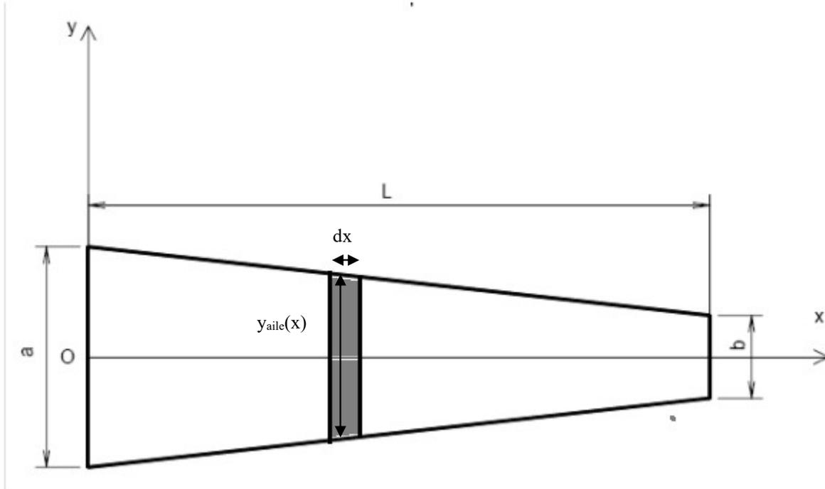
3. Calculer la résultante globale par intégration de l'action de l'air sur l'aile  $\vec{R}_{\text{air} \rightarrow \text{aile}}$
