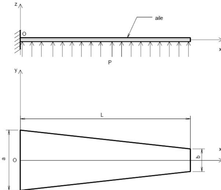
Une pression uniforme  $P$ , due à l'action de l'air s'exerce sur toute sa surface inférieure. On rappelle que  $d\vec{F}(M)_{air \rightarrow aile} = P(M).dS.\vec{z}$
