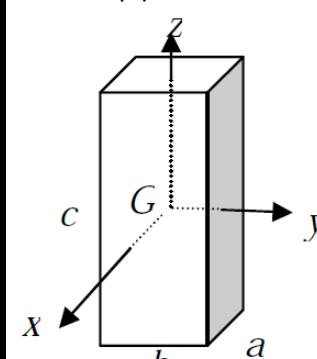
$I(G, S) = \begin{bmatrix} \frac{m(b^2 + c^2)}{12} & 0 & 0 \\ 0 & \frac{m(a^2 + c^2)}{12} & 0 \\ 0 & 0 & \frac{m(a^2 + b^2)}{12} \end{bmatrix}_{(\vec{x}, \vec{y}, \vec{z})}$                                                           |
